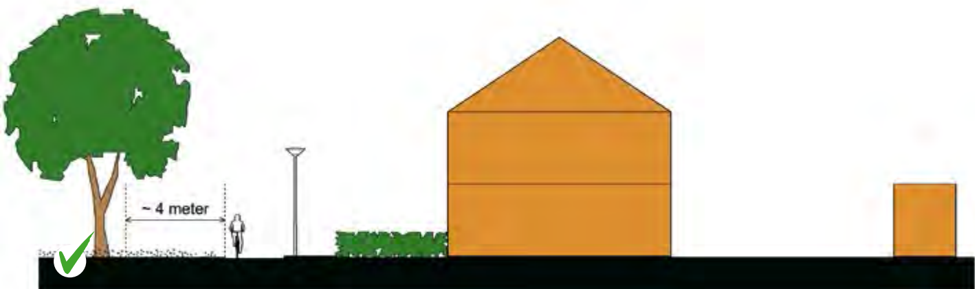
Goed: veilig fietspad door overzicht en verlichting.
