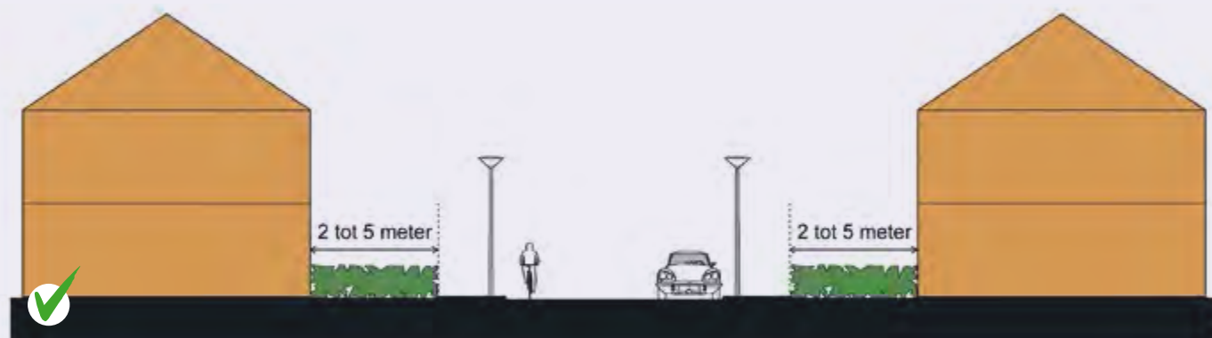
Goed: elke woning heeft een voortuin. De voordeur van de woning ligt goed in het zicht van de openbare ruimte.
